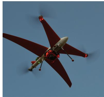
гораздо маневреннее самолетов и является одним из самых дальних дронов с вертикальным взлетом и посадкой для геодезии и маркшейдерии. Разработанный нами дрон успешно применяется в таких областях, как проектирование линий связи и карьеров, мониторинг ЛЭП. Винтокрыл позволяет делать прямую трансляцию с места ЧС, вести мониторинг территорий для предотвращения ЧС. Это полностью отвечает на запрос современного рынка, о чем свидетельствует
